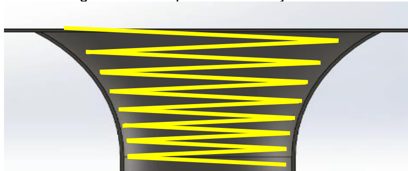
Figura 15: Estratégia helicoidal para conformação incremental da chapa.
