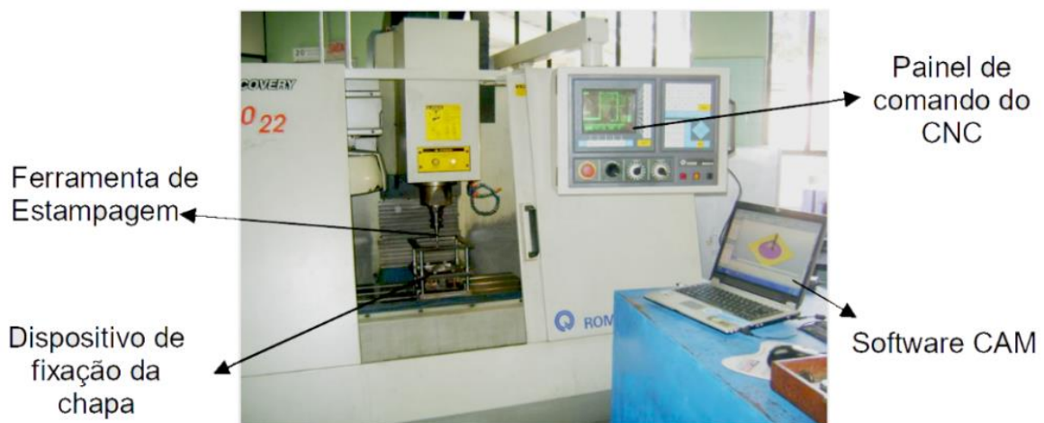
Figura 2: Máquina CNC e recursos usados para estampagem incremental
