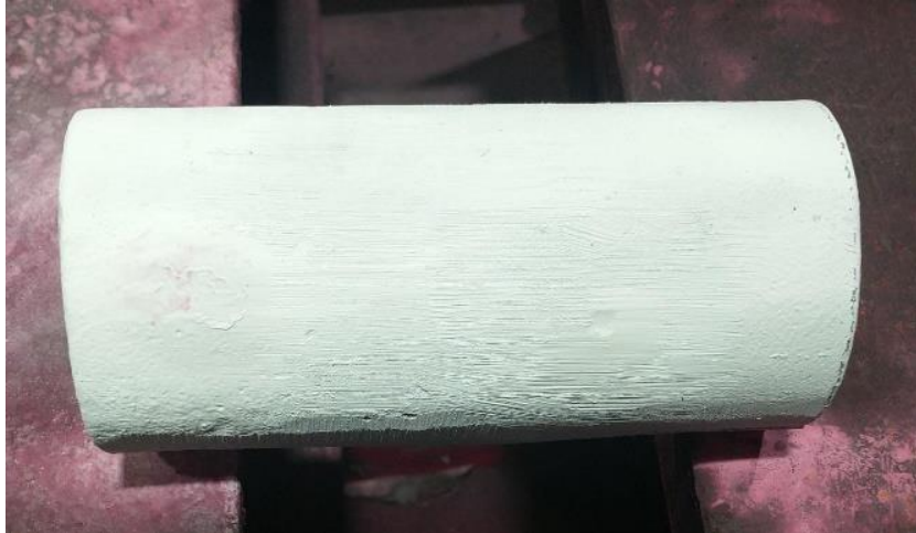
Figura 31 - Corpo de prova bruto após ensaio não destrutivo de líquido penetrante Fonte: Autoria própria
