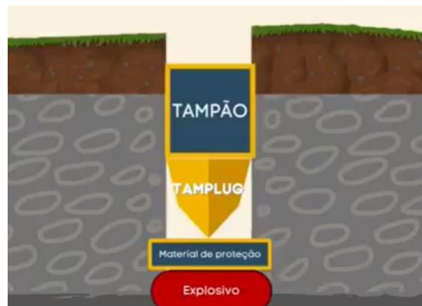
Figura 7: Aplicação de plugue no tampão.
