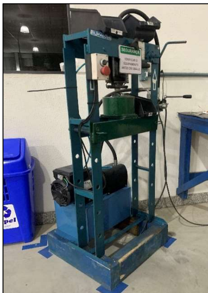
Figura 10: Prensa hidráulica automatizada
