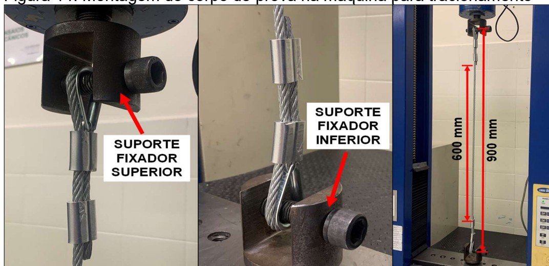
Figura 14: Montagem do corpo de prova na máquina para tracionamento
