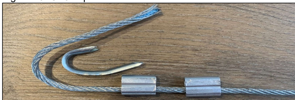
Figura 19: CP02 após o tracionamento
