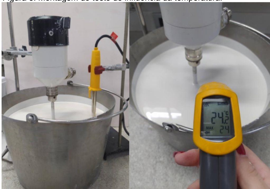
Figura 6: Montagem do teste de influência da temperatura.
