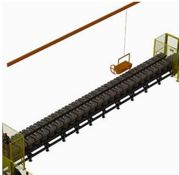
Figura 4: Linha de vazamento.
