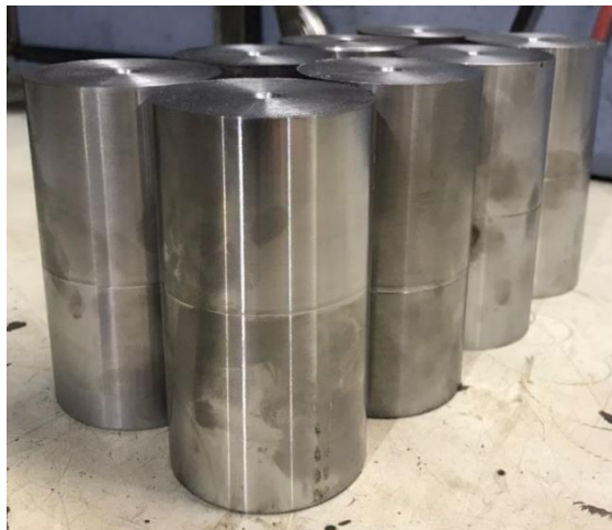
Figura 05: Corpos de prova usinados em um diâmetro e comprimento padrão de 60 x110 mm.
