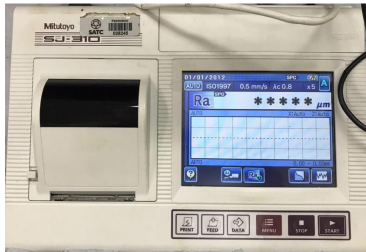
Figura 07: Rugosímetro Mitutoyo SJ 310.
