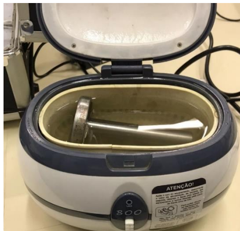
Figura 08: Equipamento elétrico de limpeza utilizando álcool.
