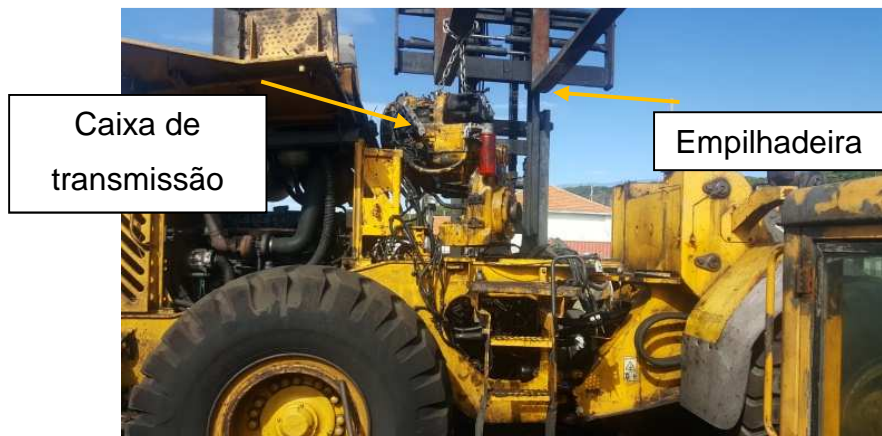
Figura 15: Retirada da caixa de transmissão, Autor (2020).
