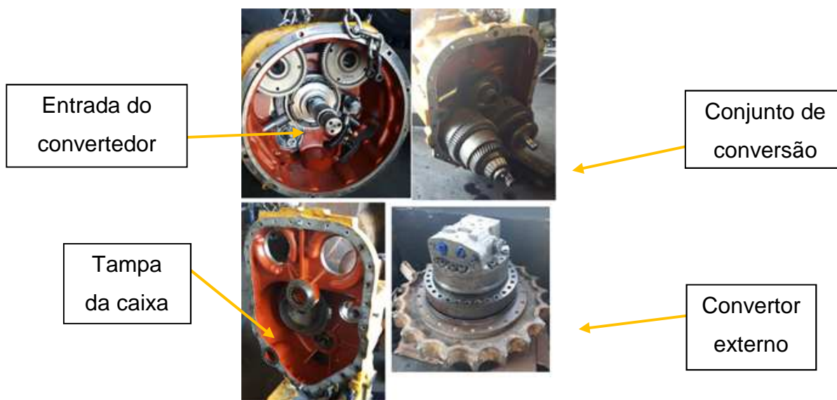
Figura 16: Caixa de conversão de torque aberta, Autor (2020).
