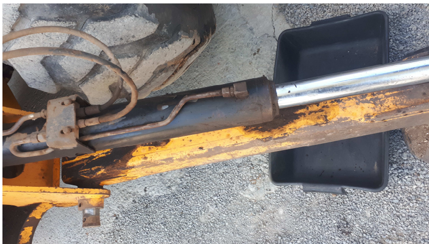
Figura 1: Cilindro com vazamento, Autor (2020).
