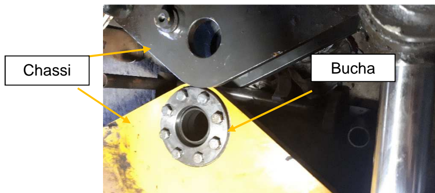
Figura 7: Afastamento do chassi, Autor (2020).
