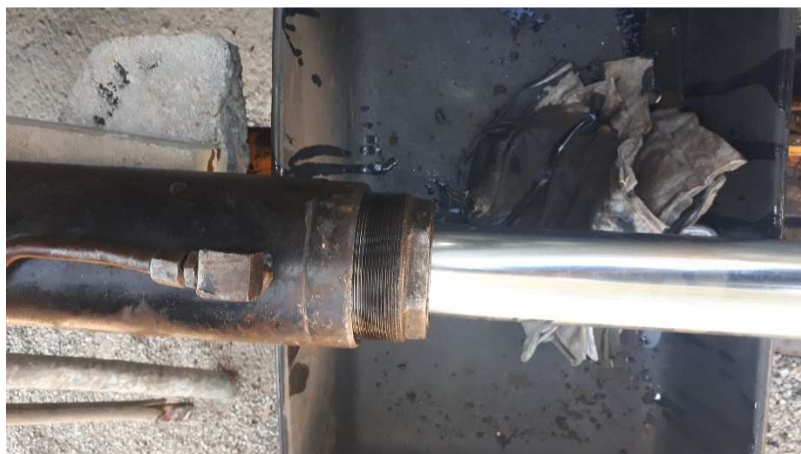
Figura 2: Desmontagem da haste, Autor (2020).
