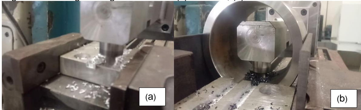
Figura 27: Usinagem rasgo de chave: (a) alumínio, (b) ABNT 1045.
