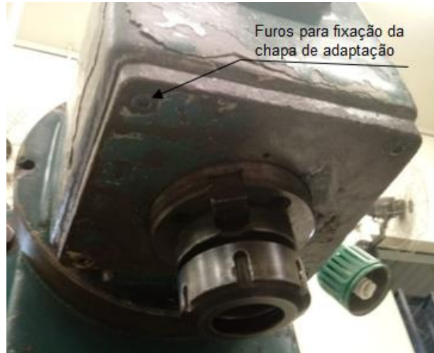
Figura 21: Chapa da Fresadora Romi U30 na SATC.
