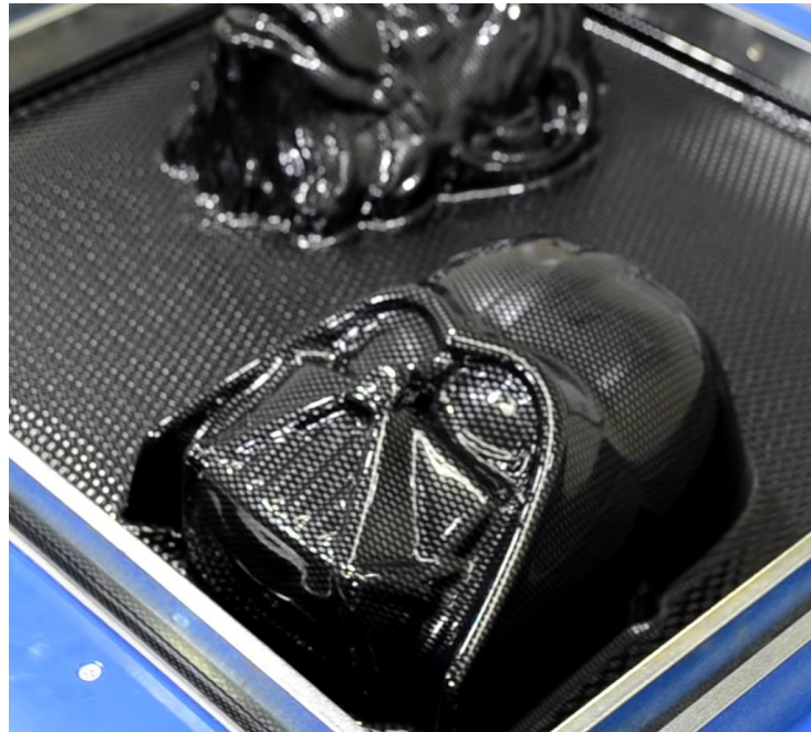
Figura 13: Processo de formação por cortina.
