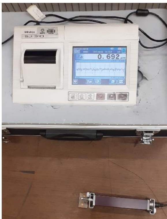
Figura 24 - Medição de rugosidade através do rugosímetro Mitutoyo SJ-310
