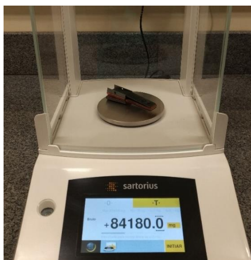
Figura 32 - Contato móvel do regulador de tensão durante ensaio de massa
