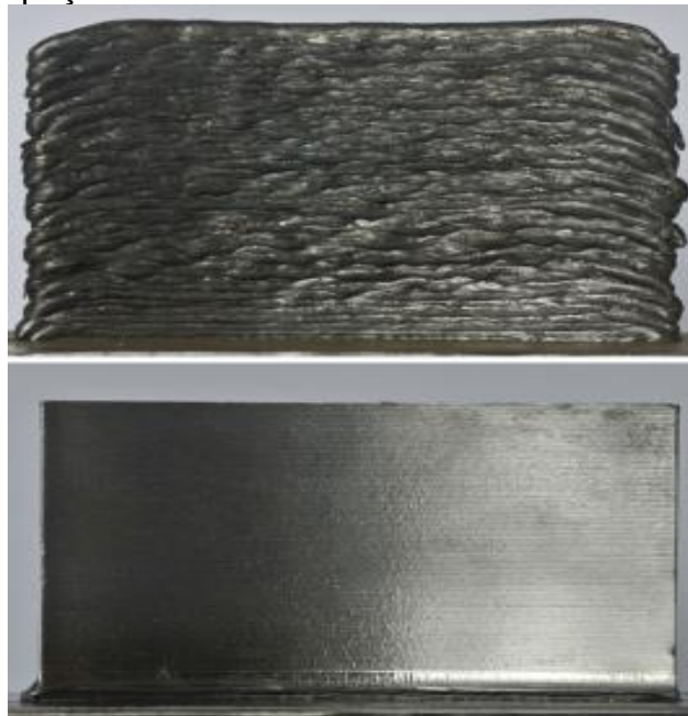
Figura 3: Acabamento por usinagem em peças manufaturadas.
