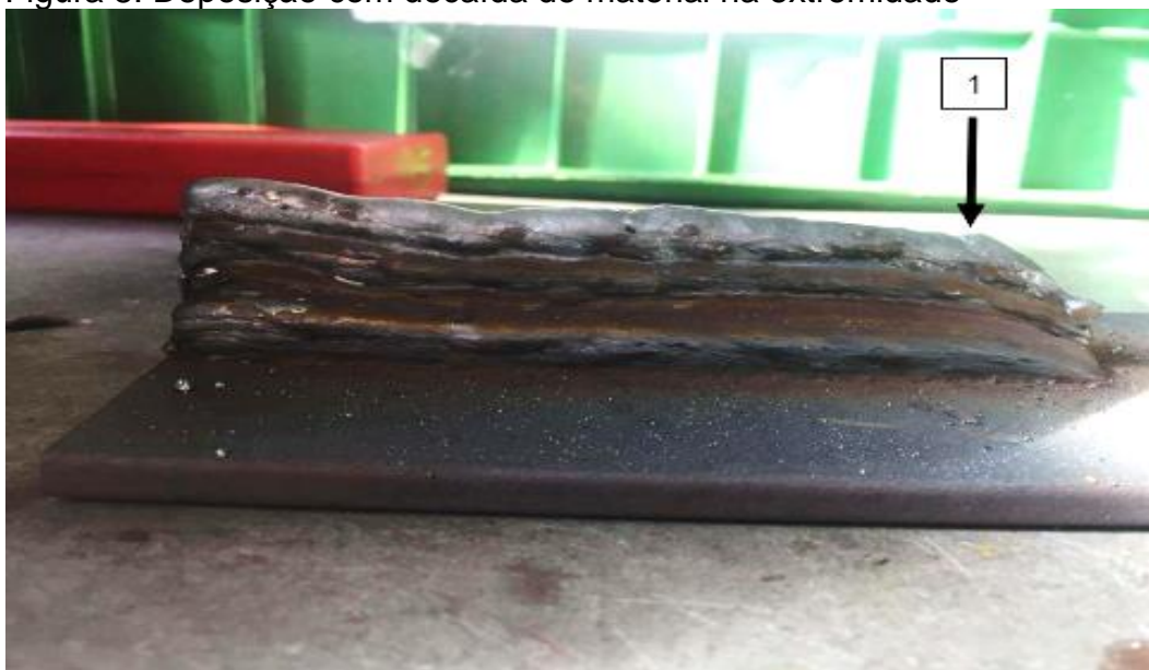
Figura 8: Deposição com decaída de material na extremidade
