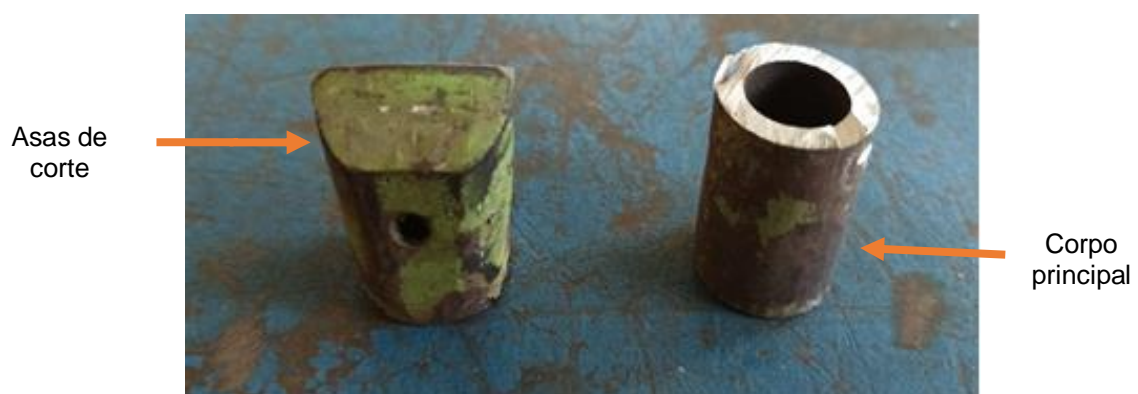
Figura 2 - Broca de perfuração de teto.
