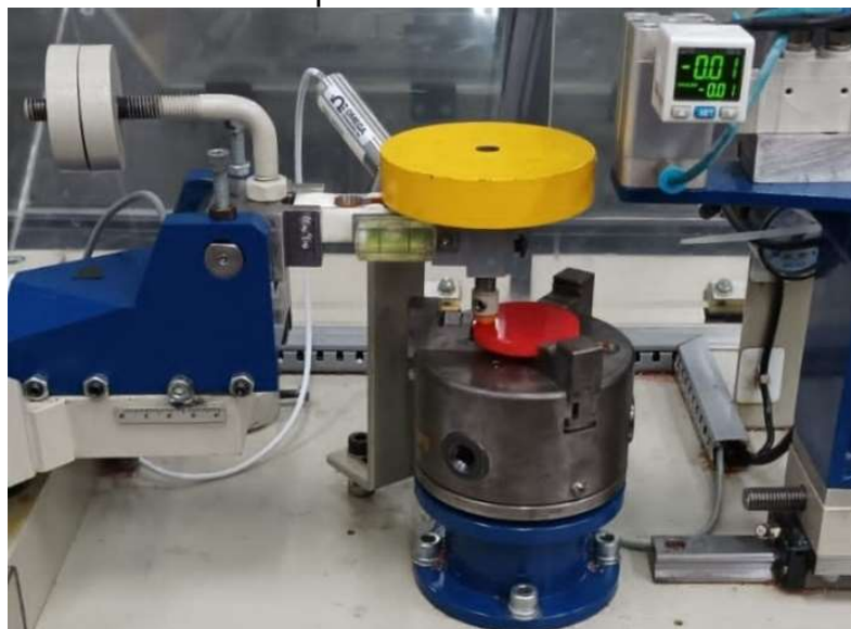
Figura 9: Ensaio para calcular o coeficiente de atrito utilizando o método pino sobre disco.
