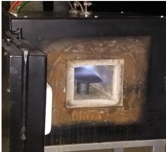
Figura 7 – Comportamento da chama com a porta aberta
