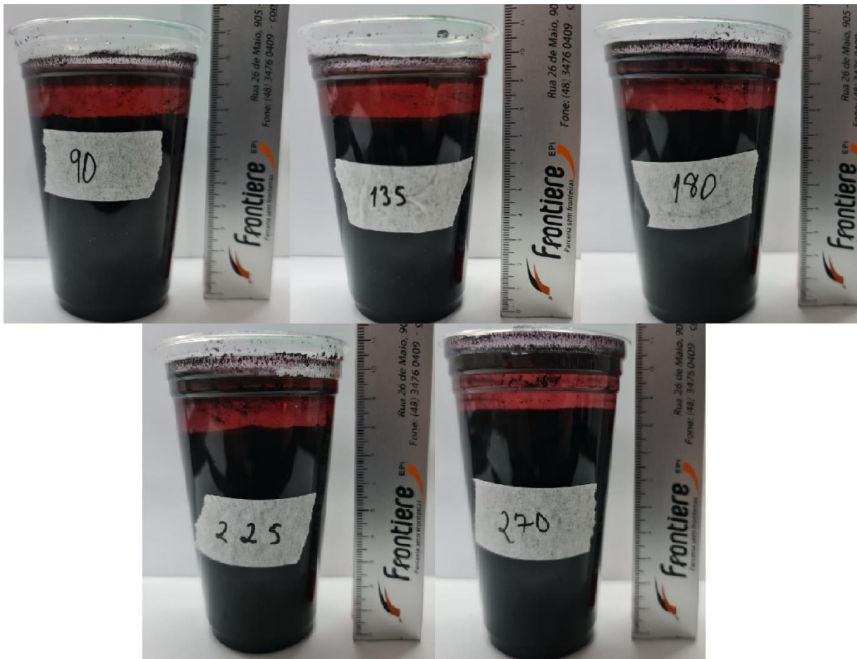
Figura 2: Separação de fases com sulfato de alumínio – 90 a 180 g.L -1 .
