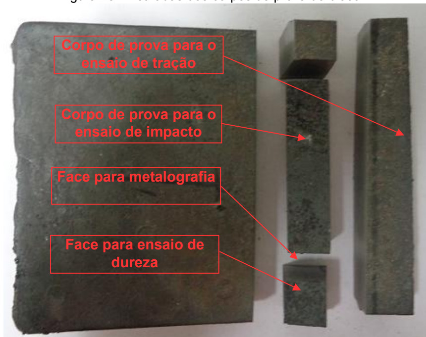
Figura 25 - Retiradas dos corpos de prova do bloco "Y"
