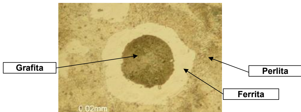
Figura 10 - Região ferrítica em torno da grafita esferoidal
