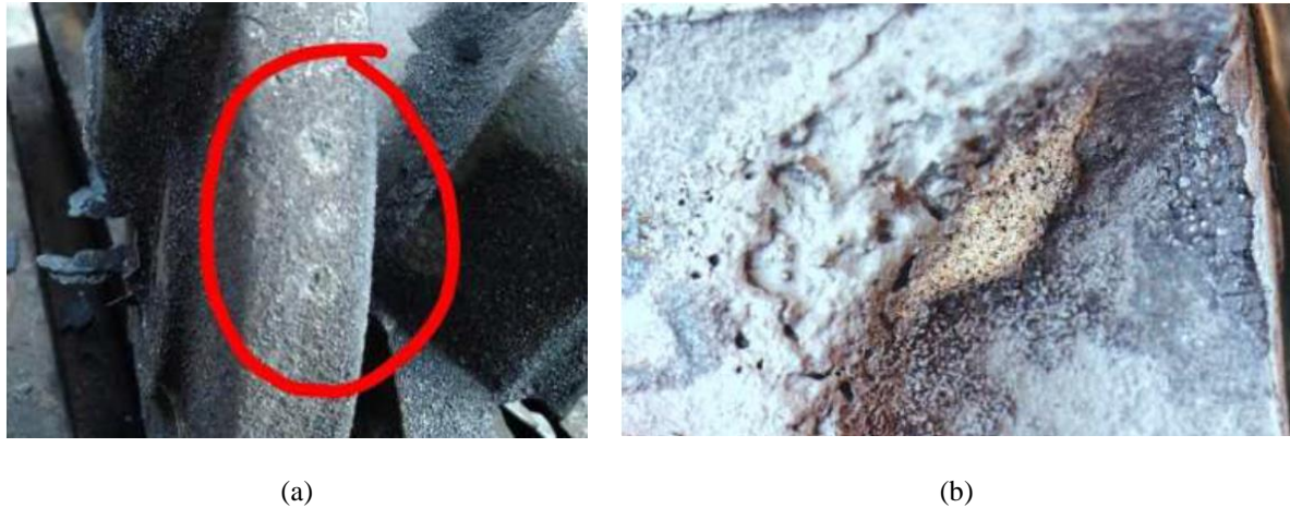
Figura 10 – Exemplos de inclusões de reoxidação na superfície de peças fundidas em aço (a) superfície com defeito (b) detalhe da inclusão (aproximado) [18]
