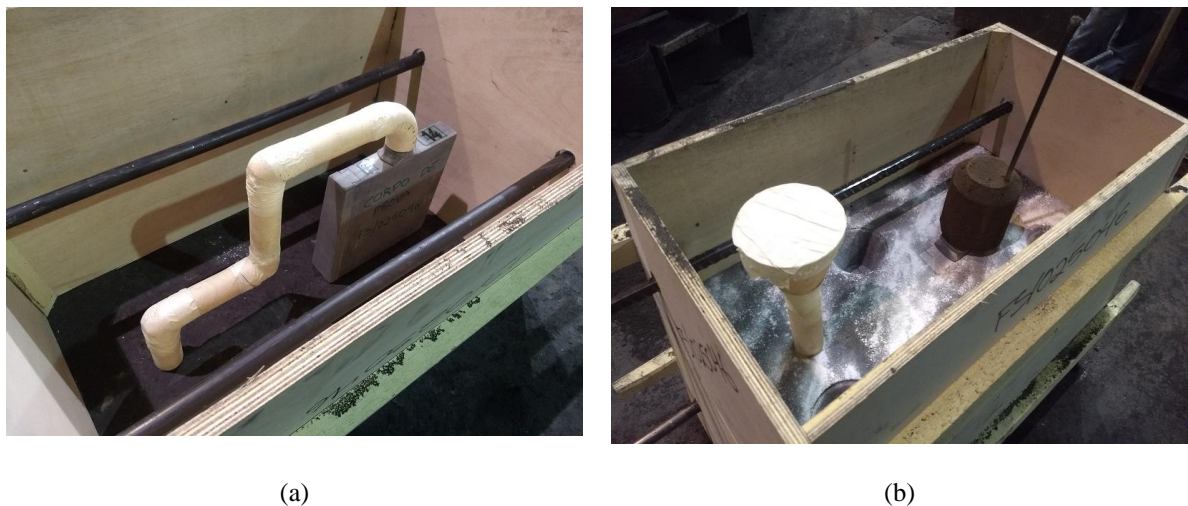
Figura 66 – Processo de moldagem do corpo de prova 14 – CP14 (a) lado do fundo (invertido) e (b) lado da tampa
