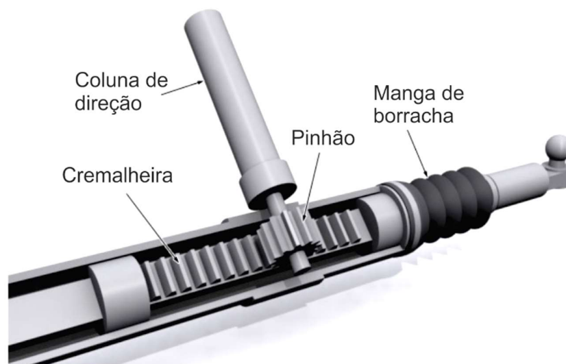
Figura 1- Exemplo sistema por pinhão e cremalheira
