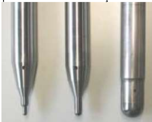
Figura 8: Exemplos de ferramentas de aço-carbono cimentadas.
