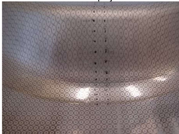
Figura 16: Exemplo de deformações representadas pela gravação de grade de círculos na peça.
