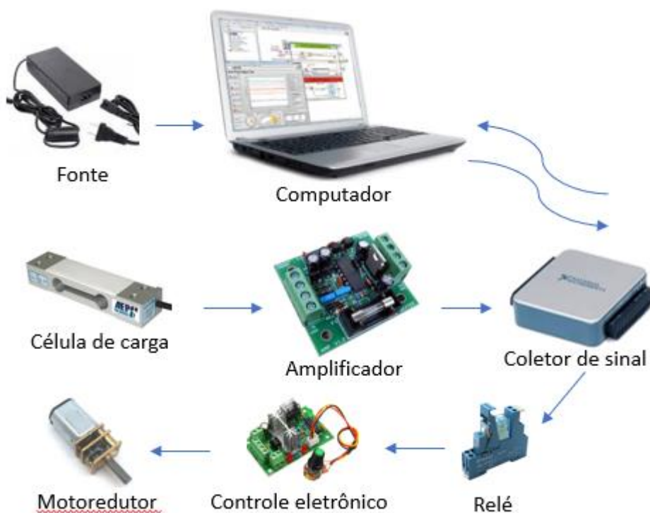
Figura 10 – Cadeia de medições da célula de carga e do relé
