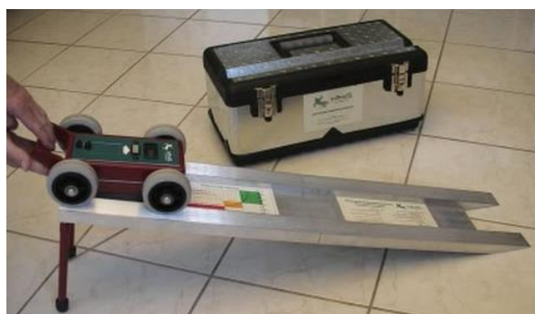
Figura 3 – Vista geral do teste Slipalert
