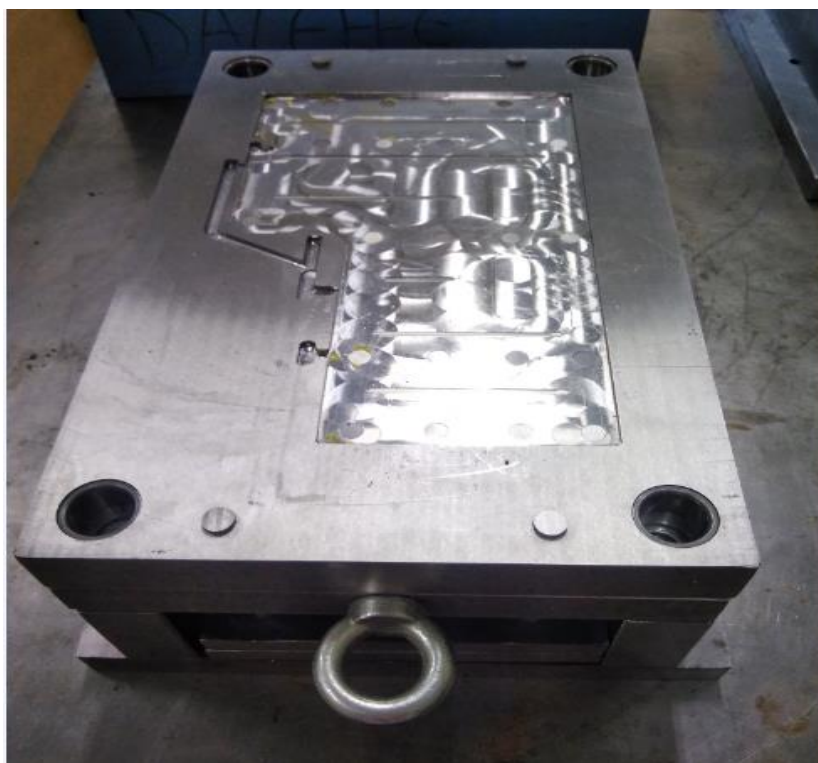
Figura 13 – Matriz para fabricação do piso tátil.
