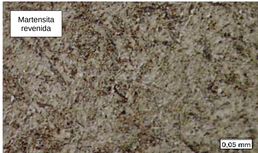
Figura 17: Microestrutura após revenimento 400°C. Ampliado 500X.
