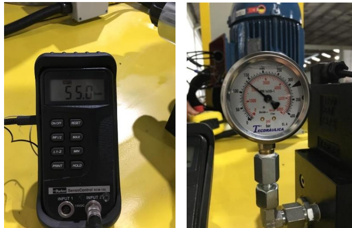
Figura 13: Medições experimentais no circuito hidráulico: a) medição de vazão volumétrica e b) medição de pressão.
