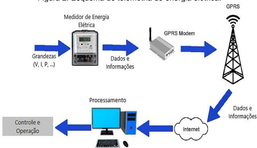
Figura 2: Esquema de telemetria de energia elétrica.
