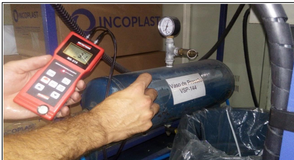
Figura 3: Inspeção de espessura, (Do autor, 2020).
