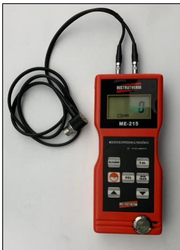
Figura 2: Medidor de espessura ultrassônico (Do autor, 2020).
