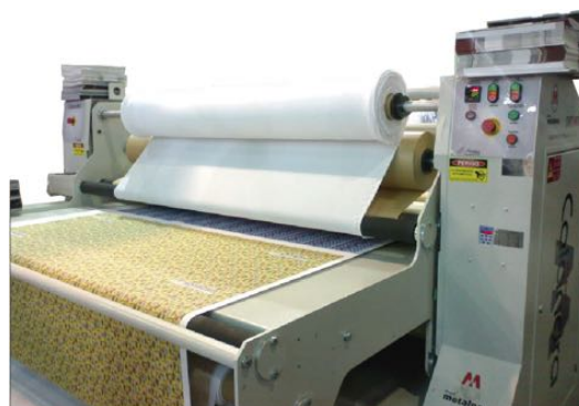
Figura 4: Representação do processo de Sublimação – Calandra Têxtil.
