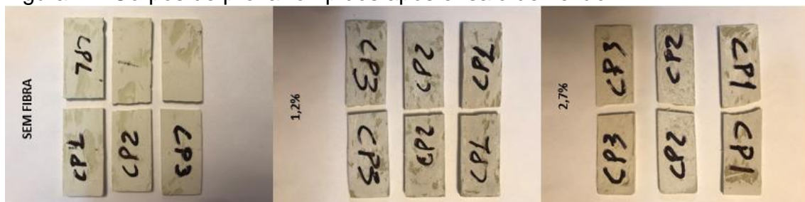
Figura 12: Corpos de prova rompidos após ensaio de flexão.
