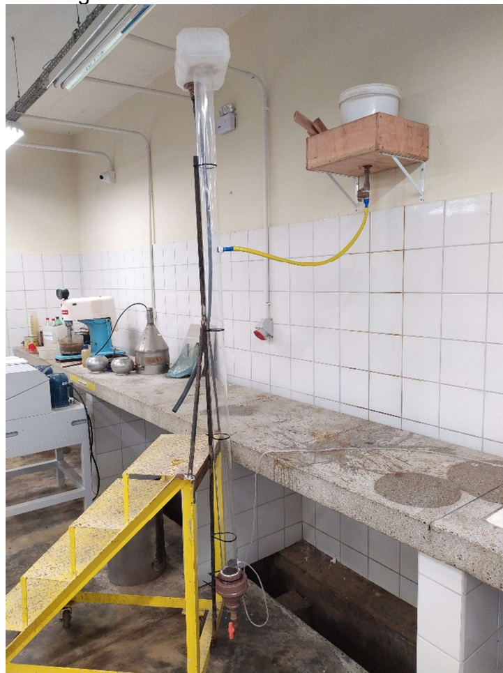
Figura 2: Flotador de coluna construído.
