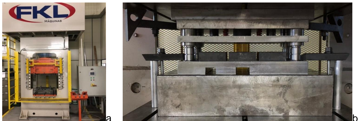
Figura 28 – Prensa hidráulica FKL (a) equipada com a matriz de estampagem (b).
