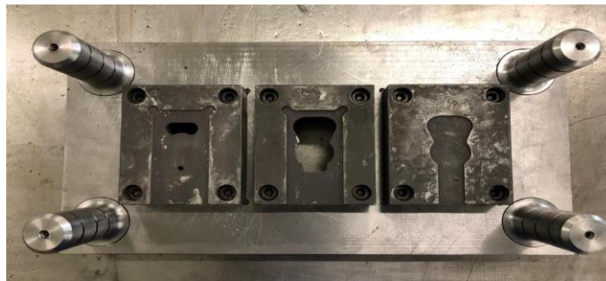
Figura 25 – Montagem das matrizes de corte na base inferior.
