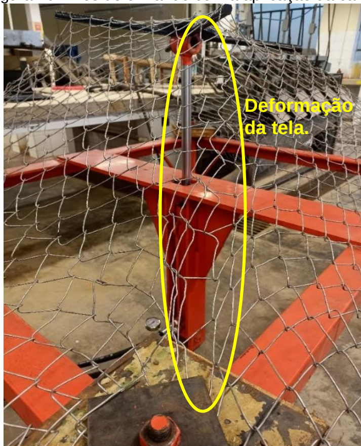
Figura 20: Fios deformando com a aplicação da carga.
