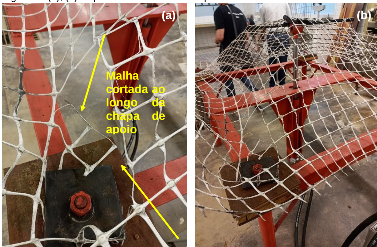
Figura 24:(a), (b) Ruptura entre a tela e a chapa metálica.
