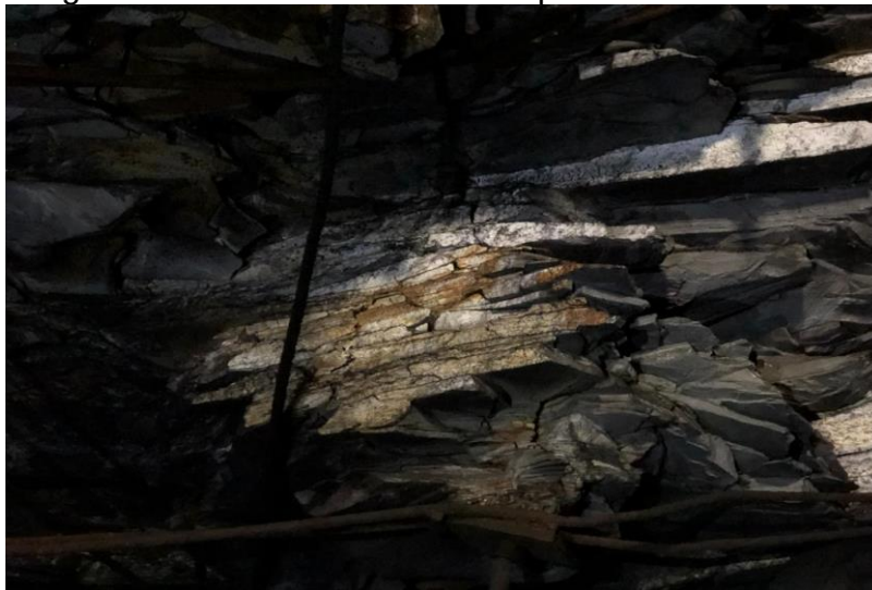
Figura 3: Teto imediato formado por arenito laminado
